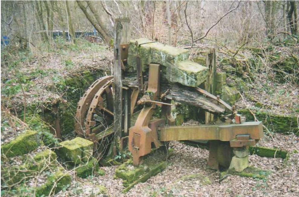
Abbildung 25: Alternlassen, Aufwerfhammer bei Wortley/GB
