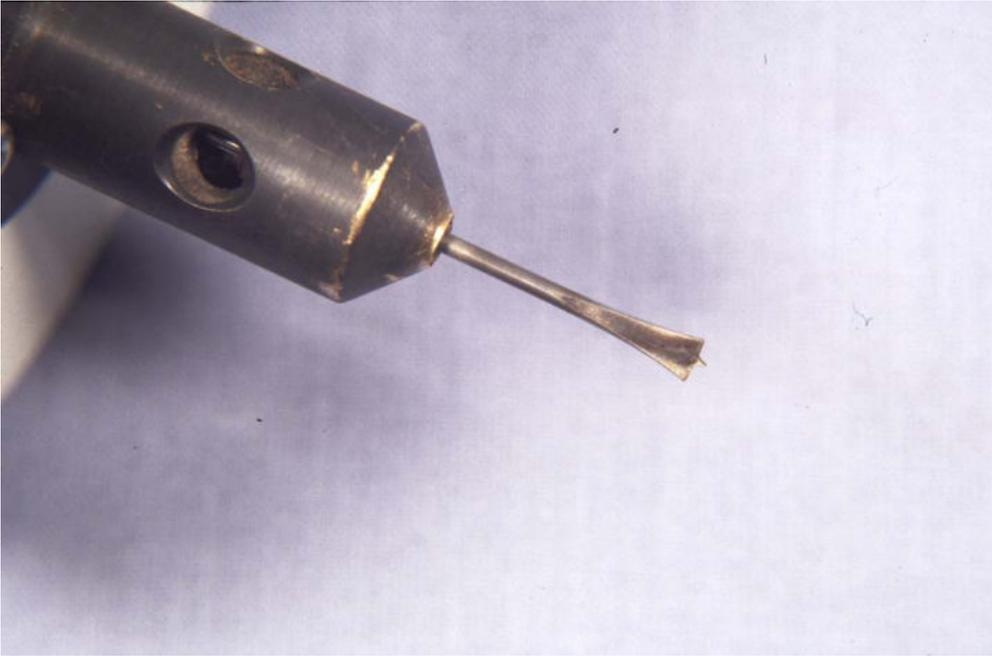
Abbildung 62: Bohrnadelkopf ( $b = 3 \text{ mm}$ ) und Führungsspitze
