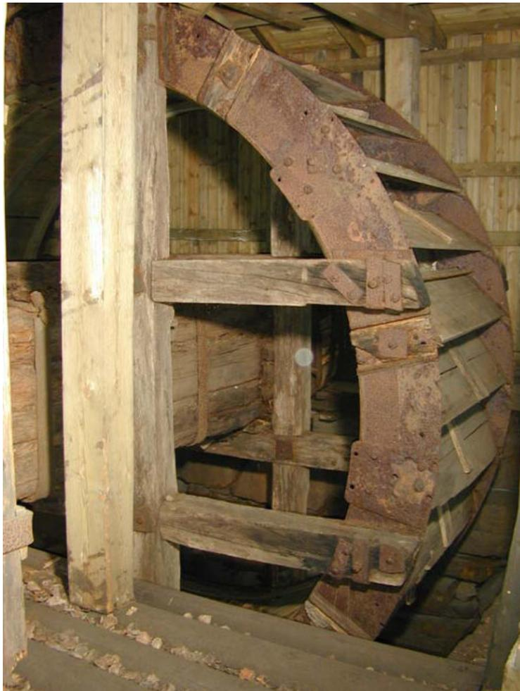
Abbildung 7: Wasserrad des Storhammers
