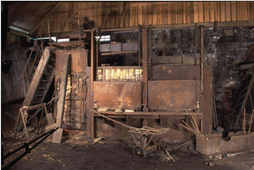
Abbildung 25: Doppelkammerofen, davor der Wagen der für den Transport der erwärmten Eisen zum Hammer verwendet wurde; rechts Wasserkasten
