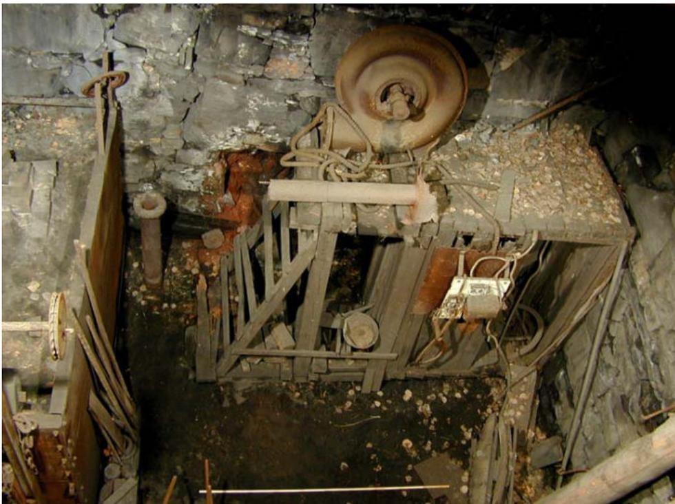
Abbildung 32: Verschlag mit Schalttafel und Kreiselgebläse; links vertikales Rohrstück für die Zuluft des Ofens
