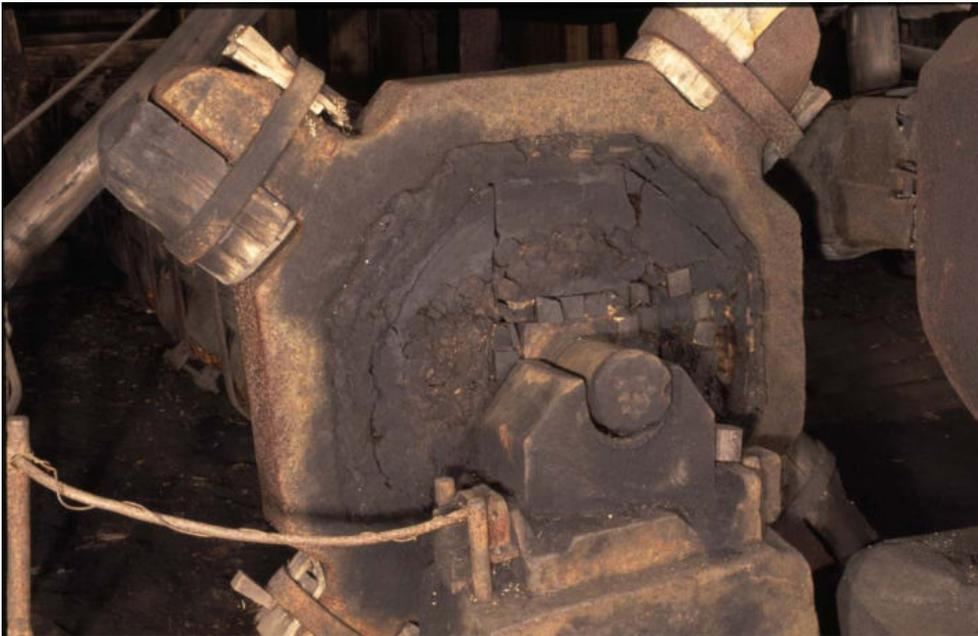
Abbildung 8: Vorderes Wellenlager mit Nockemring
