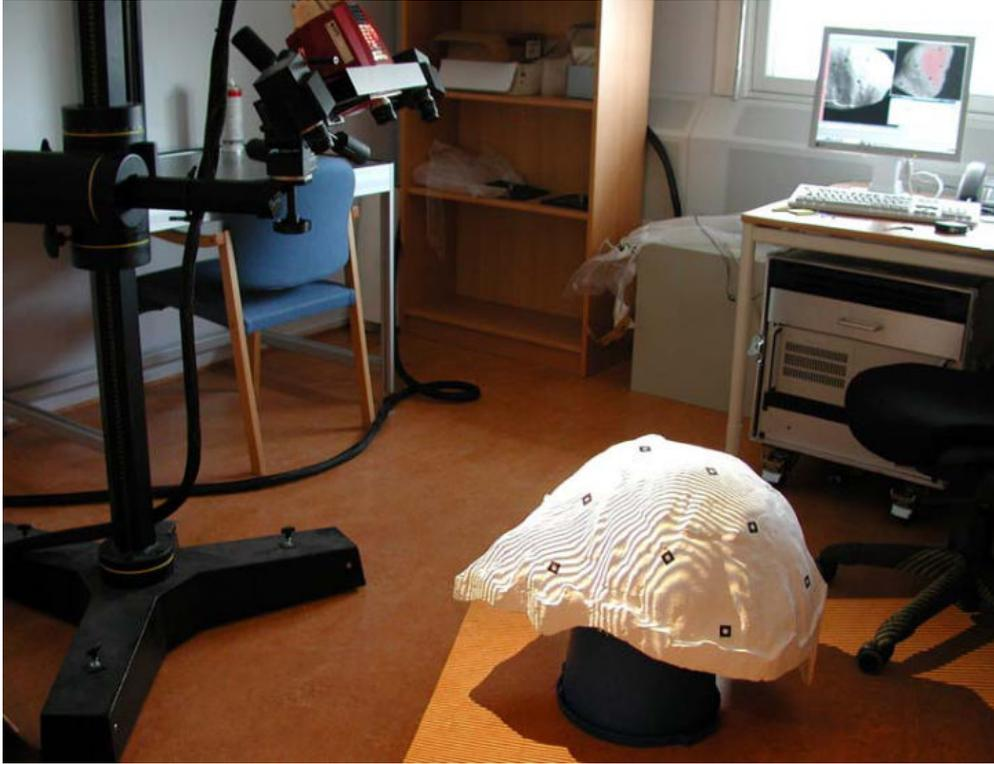
Abbildung 34: Scannen der Gips-Negativform
