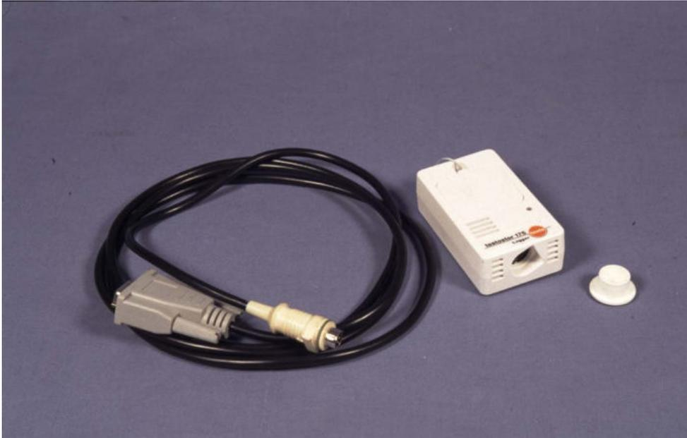
Abbildung 64: Daten Logger zur Messung von Temperatur und relativer Luftfeuchtigkeit
